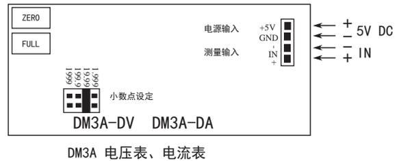
DM3A 电压表、电流表
