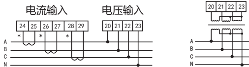
电流经CT接入 电压直接接入
