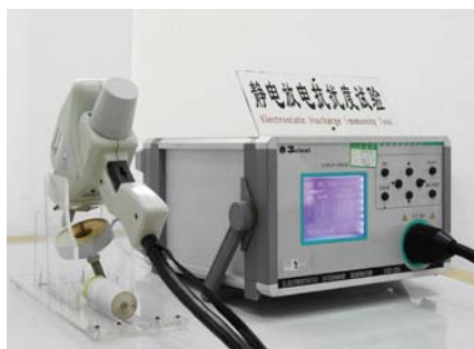
静电放电抗扰度试验
