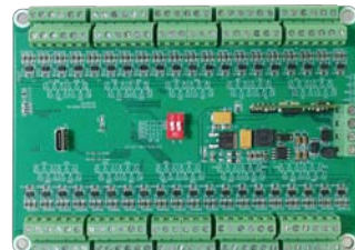
T531A(B) (T52L) 系列 16/32/40路温度采集板
