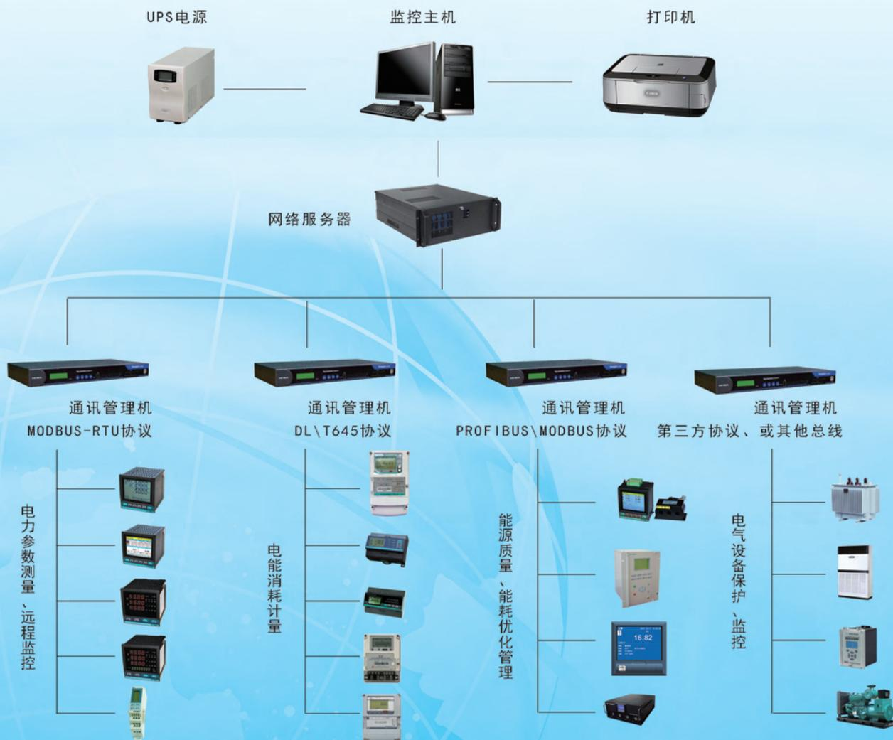
随着现代建筑及工业向信息化、智能化、人性化及节能环保方向的发展，工程项目在建设或改造过程中提出了以节能环保、智能监控、能效治理、电气安全等高度集成化的应用需求，东崎公司凭借在测量、控制、安全保护、能效治理等产品的研发及生产实力，以及结合客户实际使用过程中的技术服务和应用需求沟通积累，全新推出toky-PMS2.0版能效管理及智能监控管理系统解决方案，该系统集成有丰富的数据采集、存储、图形生成、报表输出、远程监控等功能，并精心设计出人性化的人机交互界面。可广泛应用于商业广场、小区、市政、工厂、医院、学校、变电站、发电厂等。
